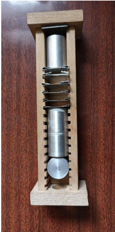
Հանքամերձ հողանմուշի նախապատրաստումը ճառագայթման և ճառագայթումը
