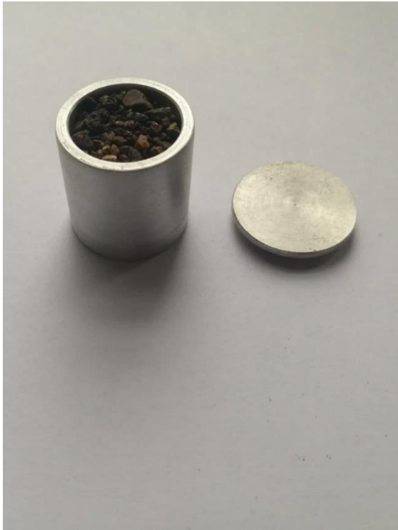
Հանքամերձ հողանմուշի նախապատրաստումը ճառագայթման և ճառագայթումը
